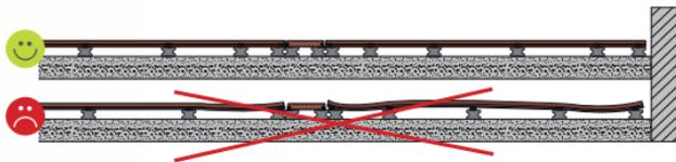
Chaque extrémité de lame doit avoir 2 lambourdes espacées d'un entraxe de 180 mm maxi. Pour la fixation de la lame intermédiaire perpendiculaire, voir page 12.
